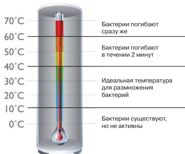
Для борьбы с бактериями использование одного лишь хлорирования в системах горячего водоснабжения недостаточно, так как существуют бактерии довольно устойчивые к хлору. Именно поэтому в аккумуляторных баках систем LESSAR Heat Pump введена функция автоматического уничтожения бактерий посредством их термической обработки.
