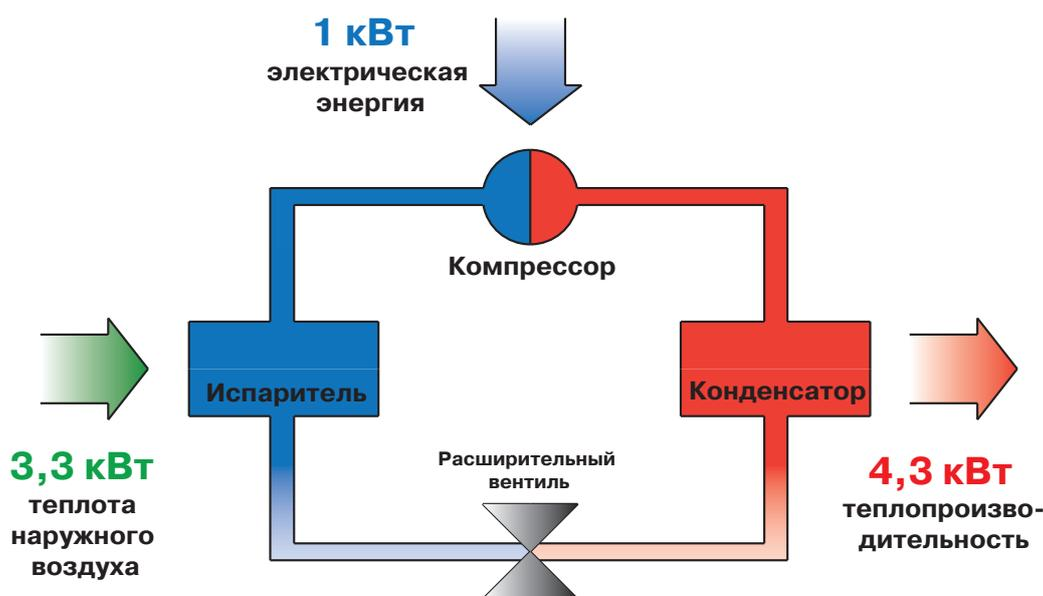
Далее этот поток поступает в теплообменник (испаритель), связанный с окружающей средой (например, воздушный теплообменник на улице). При низком давлении жидкость испаряется (превращается в газ) при температуре ниже,
